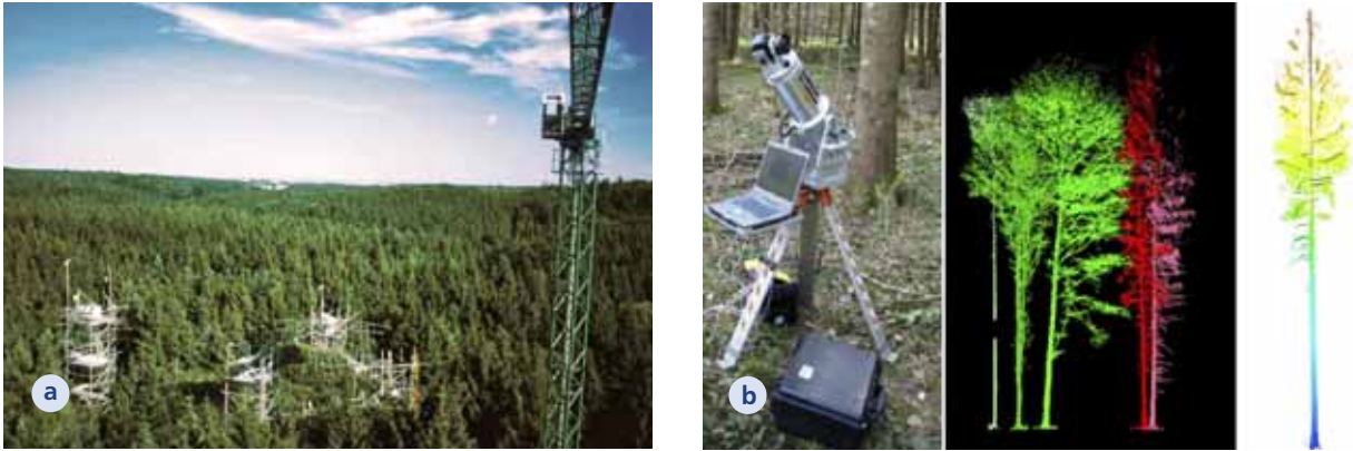
Abbildung 15: Detaillierte Erfassung der Kronenstruktur durch Anwendung von Gerüst, Kran und Laser-Scanning. Ergebnisse solcher punktuell ausgeführter Sonderuntersuchungen sind beispielsweise (a) detaillierte Informationen über Stammformveränderung von Fichte und Buche infolge von langfristiger Ozonbelastung und (b) über terrestrischen Laser-Scanner erfasste dreidimensionale Kronenmorphologien in Rein- und Mischbeständen. Fotos: (a) K.-H. Häberle (b) Lehrstuhl für Waldwachstumskunde
