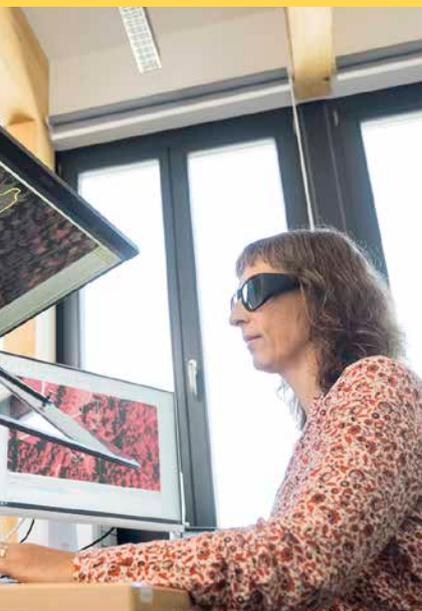
2 Am 3D-Monitor werden an der LWF stereoskopische Luftbilder ausgewertet. Durch den räumlichen Eindruck können, im Vergleich zur 2D-Interpretation, einzelne Bäume besser unterschieden und noch zuverlässiger interpretiert werden. Foto: Tobias Hase
