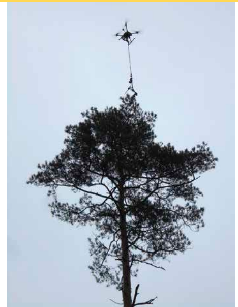
Probenentnahme mit Hilfe einer Drohne mit speziellem Anbaugerät Foto: Simon Ecke, LWF
