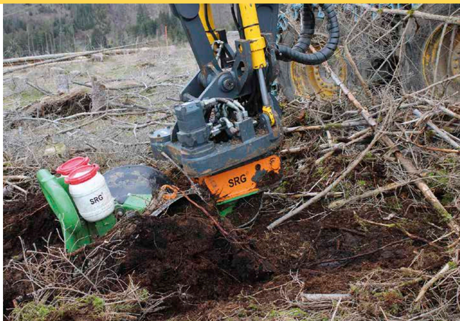
2 Harvestersaatkopf, bestehend aus einem Scheibenräumgerät mit angeschlossener Aus-saatvorrichtung für Samen unterschiedlicher Größe (weiße Behälter) Foto: P. Dimke, LWF
