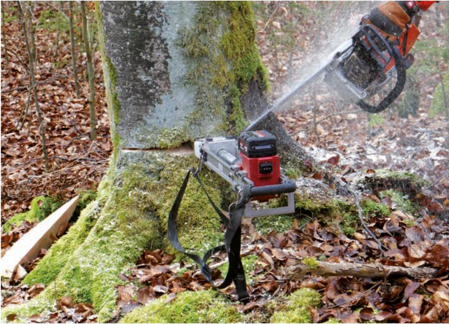
Abbildung 4: Fernbedienbarer mechanischer Fällkeil Foto: M. Bossenmaier
