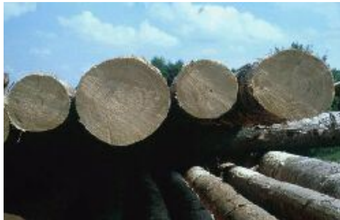
Abb. 13: Detailansicht eines Polters; Lagerschäden wie Rotstreifigkeit und Bläue sind nicht vorhanden [Foto: INSTITUT FÜR HOLZFORSCHUNG]
