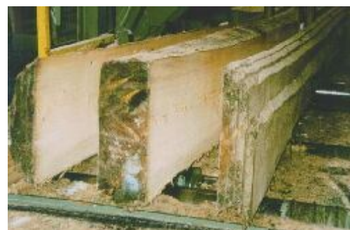
Abb. 21 und 22: Über mehrere Jahre nassgelagerter Fichtenstamm vor und nach dem Einschnitt [Fotos:
