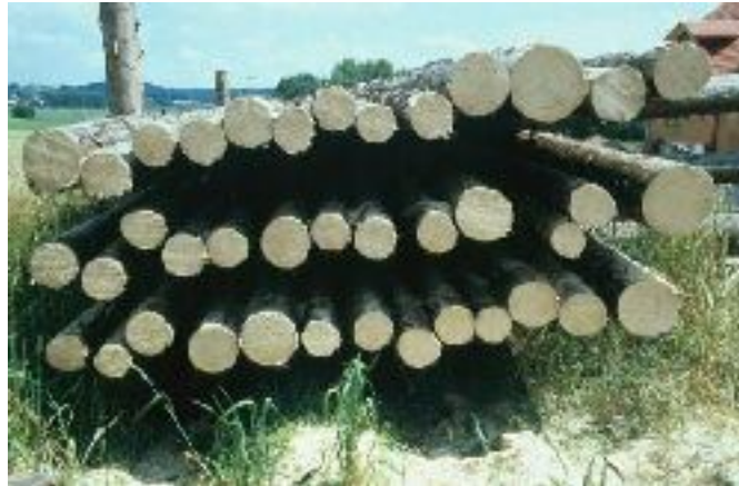
Abb. 12: Holzqualität der Versuchspolter in der Nähe Münchens nach viermonatiger Lagerdauer, frische Querschnitte [Foto: INSTITUT FÜR HOLZFORSCHUNG]
