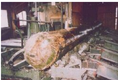
Abb. 21 und 22: Über mehrere Jahre nassgelagerter Fichtenstamm vor und nach dem Einschnitt [Fotos:
