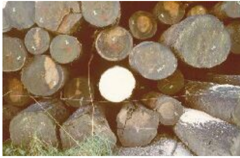
Abb. 20: Bewachsene Stirnseiten und frischer Anschnitt [Foto: LWF]
