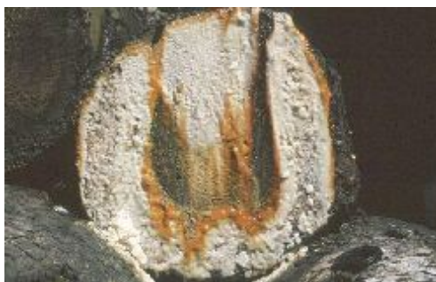
Abb. 19: Stirnseitenbewuchs nach längerer Beregnung [Foto: LWF]
