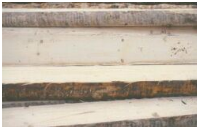
Abb. 7: Aus entrindet gelagertem Holz geschnittene Bohlen [Foto: WAUER]
