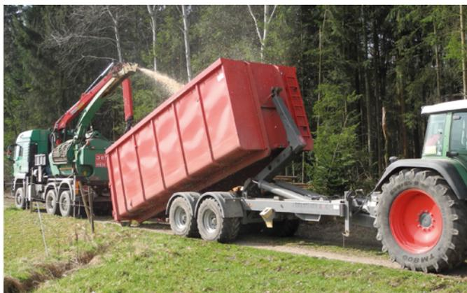
Maschinenaufstellung bei geringer Wegebreite
