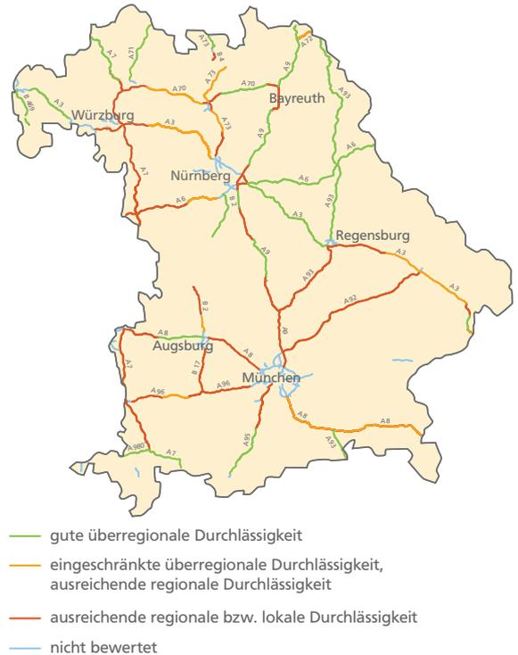
Abbildung 4: Angestrebte Durchlässigkeit der Bundesfernstraßen für den überregionalen und landesweiten Biotopverbund
