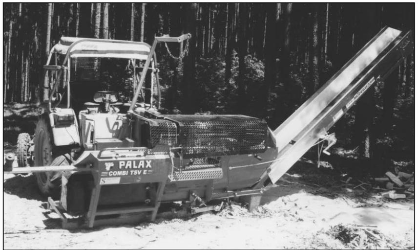
Abb. 1: Säge-Spalt-Maschine „Palax Combi TSV E“
