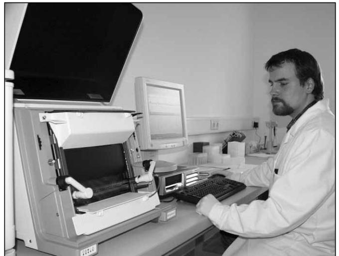
Abb. 2: Gerät zur automatischen Analyse der DNS-Sequenz, Foto: ASP
