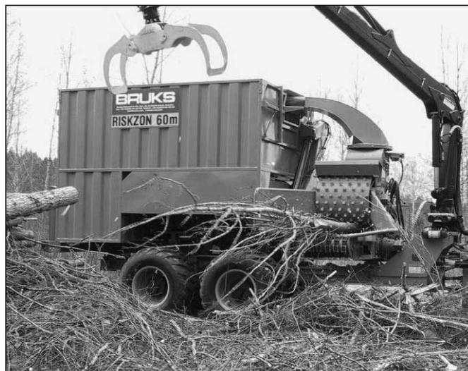
Abb. 3: Mobilhacker mit Schnitzelbunker auf Rückezug
