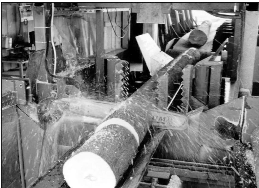
Abb. 3: Säge-Spalt-Maschine „Kretzer Herkules II“
