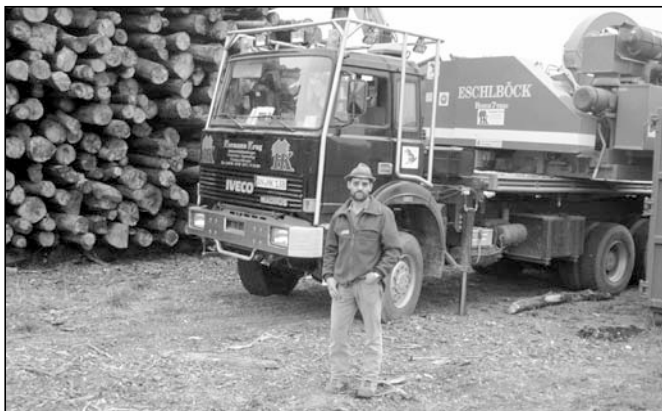
Abb. 1: Forstunternehmer HERRMANN KRUG aus Mittelfranken vor seinem kranbeschickten, auf einen LKW montierten Hacker
