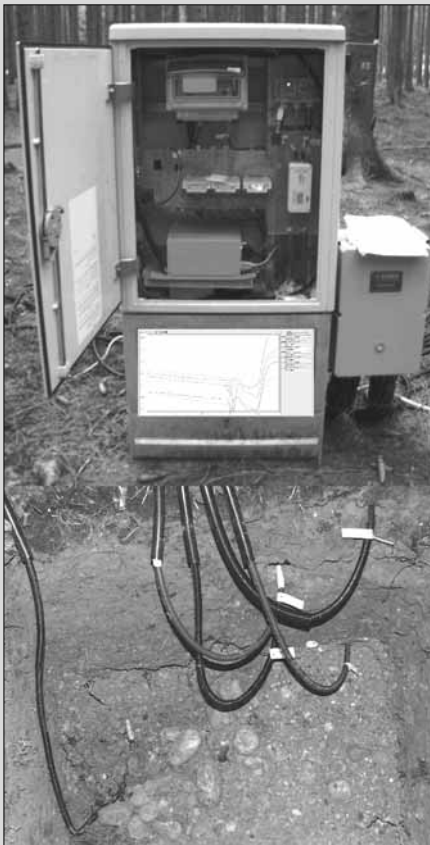
Abb. 5: Bodenfeuchte-Messeinrichtung an der Waldklimastation Ebersberg
