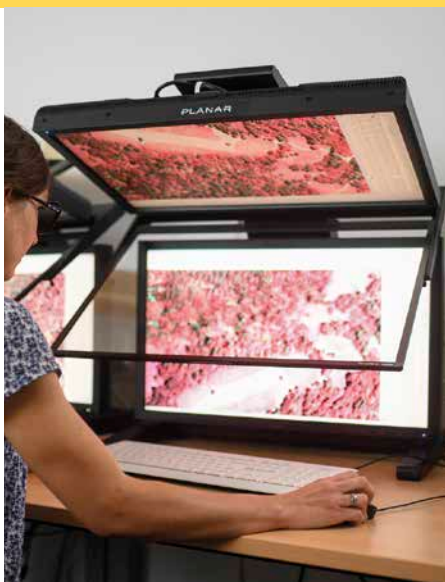
6 Die Referenzdaten für die automatische Auswertung werden am Stereoarbeitsplatz durch manuelle 3D-Digitalisierung abgegrenzt.
