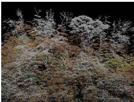
6 Im LWF-Projekt AirLaserSpec wird die Erfassung von Laubholzschäden mit flugzeuggestütztem Laserscanning und simultan aufgezeichneten Multispektraldaten erprobt. Belaubte und entlaubte Baumkronen können visuell in der Punktwolke erkannt werden. Foto: Johannes Jurgovsky
