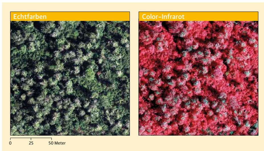
4 Echtfarben- und Color-Infrarot-Darstellung der durch die Multispektralkamera erfassten Bilddaten
