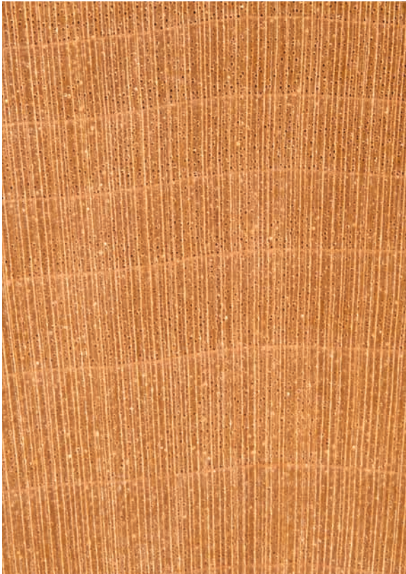
Abbildung 5: Feldahorn, Querschnitt. Lupenbild im Maßstab 7:1. Gefäße in zerstreuporiger Anordnung, fein und wenig zahlreich; Holzstrahlen schmal und enggestellt; Jahrringgrenzen gut ausgeprägt Foto: R. Rosin
