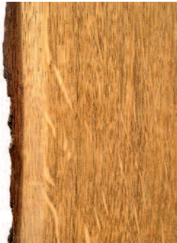
Abbildung 5: Holz der Eiche, Spiegelschnitt, Radialschnitt Foto: Holzforschung München
