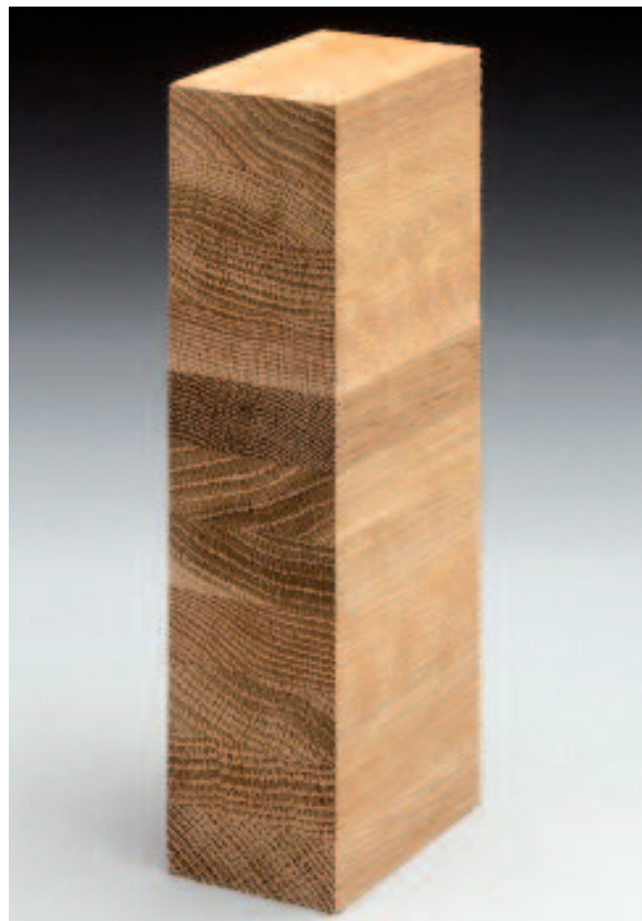
Abbildung 15: Modell Eichenbrettschichtholz. Foto: Holzforschung München
