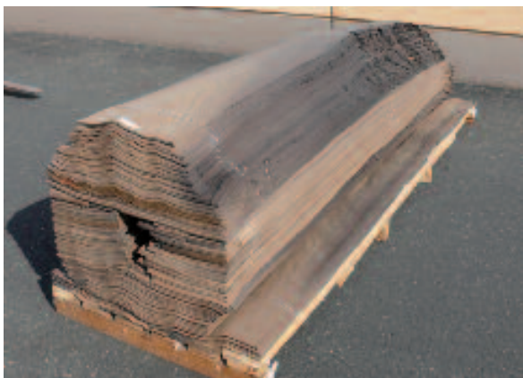
Abbildung 9: Eiche, die zur Mooreiche wurde; die grauschwärzliche bis dunkelbraune Färbung des Holzes ist nicht gleichmäßig über den gesamten Querschnitt ausgeprägt.
