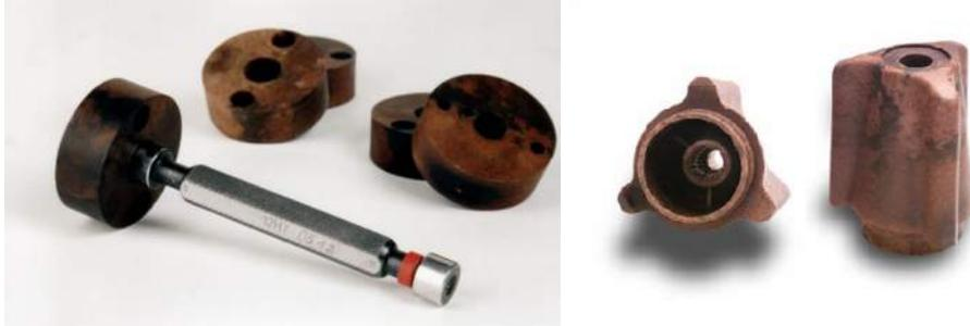
Abb. 98: Kunststoffe basierend auf Lignin (Quelle: Arboform, Tecnar GmbH)
