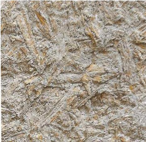
Abb. 96: Zementgebundene Faserplatte (Quelle: Holztechnologie 6/2007. DGfH)
