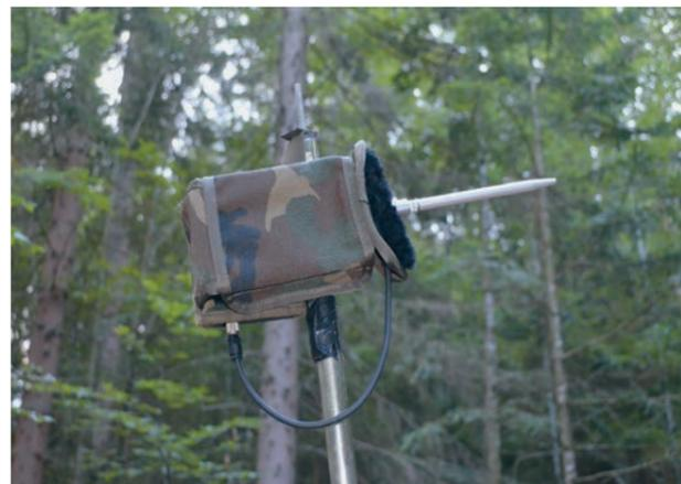
Abb. 1: Rufaufzeichnungsgerät (batcorder, ecoObs GmbH, Nürnberg) auf einer der Untersuchungsflächen (Bild: Markus Blaschke/LWF).
