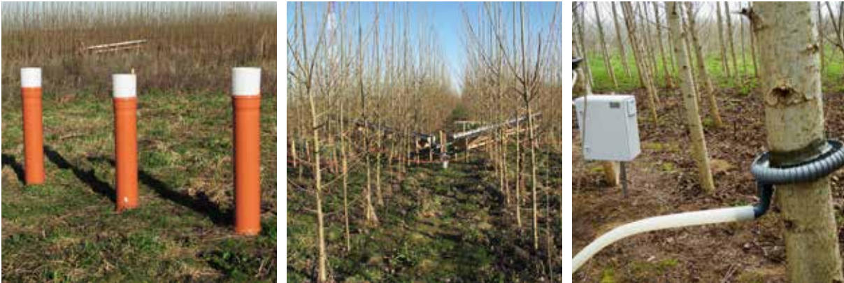
Abbildung 5: Instrumentierung zur Erfassung des Niederschlages; links: Depositionssammler Freiland; mittig: Niederschlagsrinnen zur Erfassung des Bestandsniederschlags unter den Pappeln; rechts Stammabflussrinne Fotos: M. Zacios
