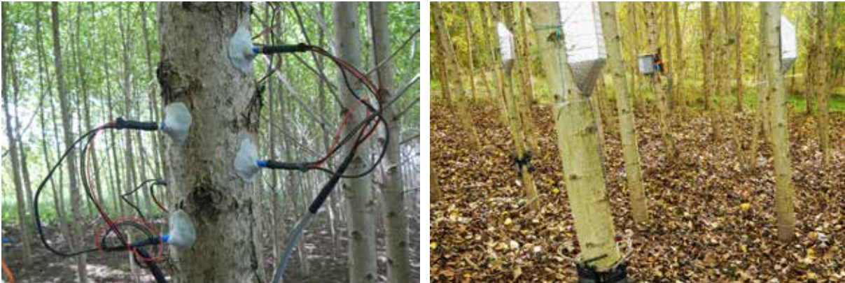
Abbildung 7: links: TDP-Sensoren; rechts: vier TDP- (oben) und vier HRM-Sensoren (unten) parallel an einer 10 cm dicken Pappel Fotos: M. Zacios
