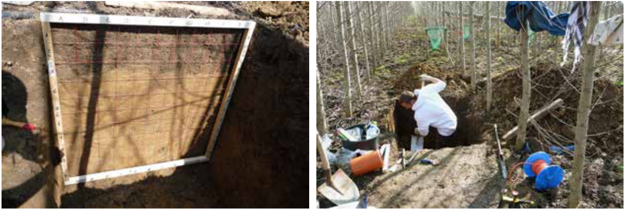
Abbildung 6: Bestimmung der Durchwurzelungsintensität (Wurzelspitzen pro \text{dm}^2 )
