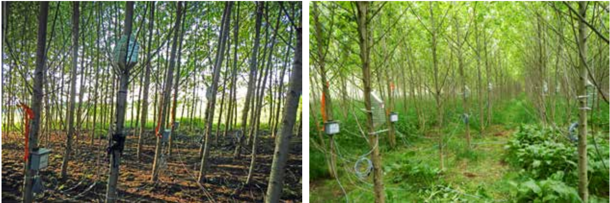
Abbildung 8: Saftflussmessungen mit TDP-Sensoren; links: Löss-Standort; rechts: Schotter-Standort
