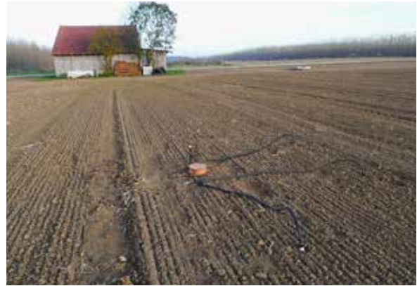
Abbildung 4: Saugkerzenplot (T1) mit vier Saugkerzen auf der Ackerfläche (links im Hintergrund die Intensivmessfläche KUP konv., rechts im Hintergrund KUP ökol.)
