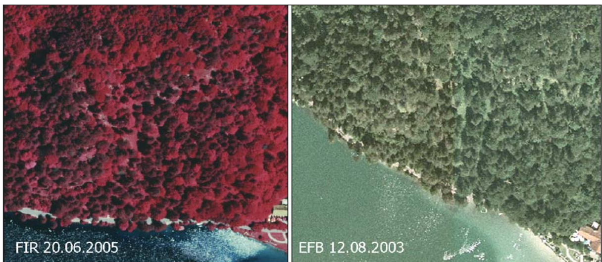
Abb. 19: Gegenüberstellung der Differenzierbarkeit von Baumarten im Farbinfrarot-Luftbild 3 (links) und im Echt-farben-Luftbild 4 (rechts); während sich im Farbinfrarot-Luftbild deutlich dunkle Partien (Nadelholz) und helle Partien (Laubholz) voneinander abheben, zeigt sich diese Differenzierung im Echt-Farb-Luftbild nicht.
