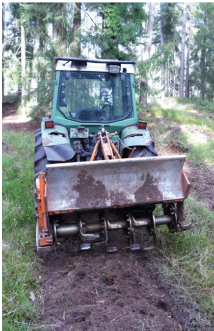
Kleinschlepper mit Fräse für die Bodenbearbeitung auf Standorten mit Zwergsträuchern und Humusaufgabe. Die Frässtreifen mit ca. 80–100 cm Breite können anschließend händisch mit Eiche eingesät werden.
