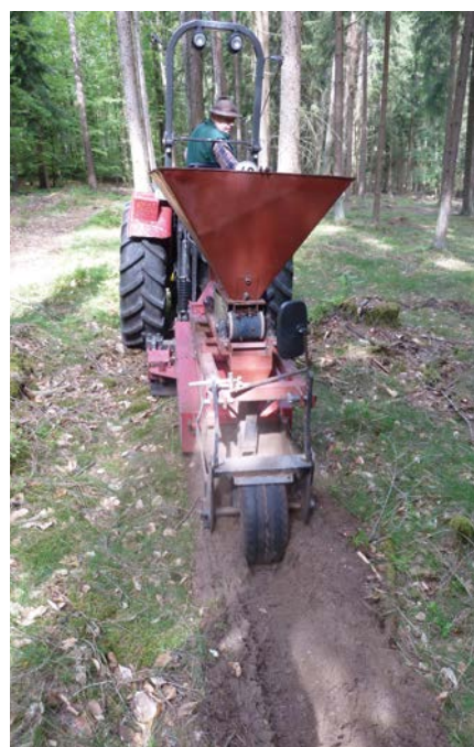
Rotbuchensaat mit langsam laufender Fräse und Saatgerät an Kleinschlepper.
