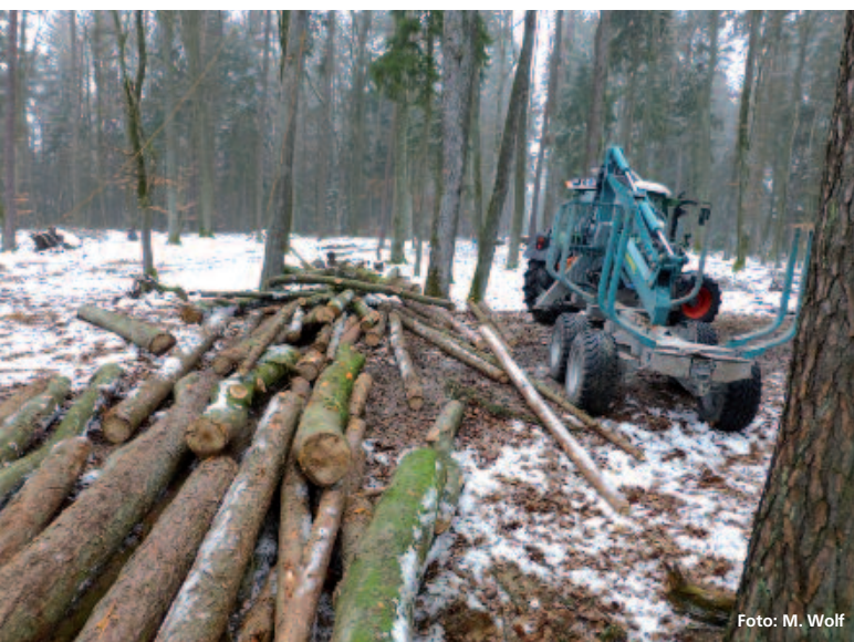
Abbildung 9: Ein Schlepper mit Rückeanhänger sammelt das Holz auf und legt sortimentsweise an geeigneten Stellen Polter an.
