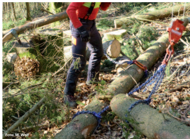
Abbildung 5: Sobald ein Stamm angehängt ist, kann nur noch in begrenzter Entfernung zugehängt werden. In diesem Fall liegen die Stämme nah genug.
