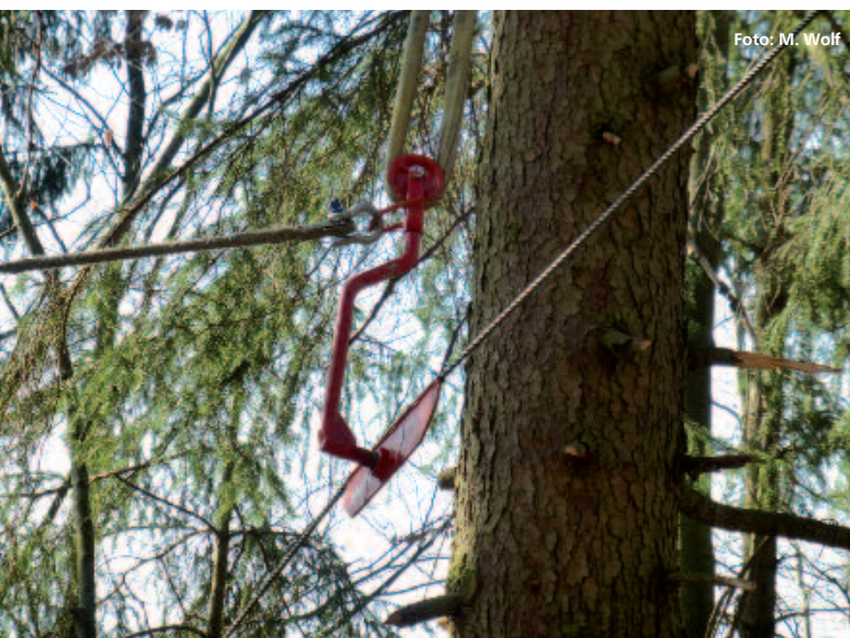
Abbildung 1: Eine überfahrbare Stütze sichert bei langen Seiltrassen oder Geländekanten eine ausreichende Tragseilhöhe.
