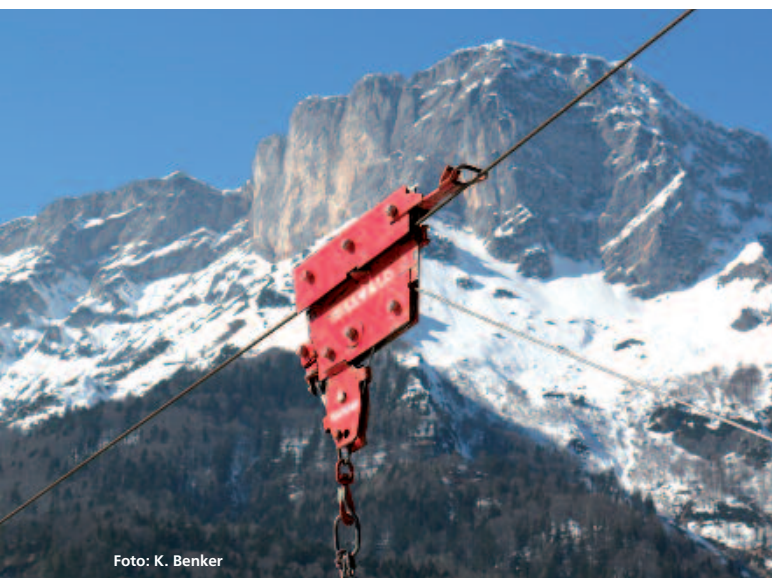
Abbildung 4: Der leichte Laufwagen ist technisch sehr einfach gehalten. Durch das Hubrollensystem verdoppelt sich die Kraft beim Anheben der Last.
