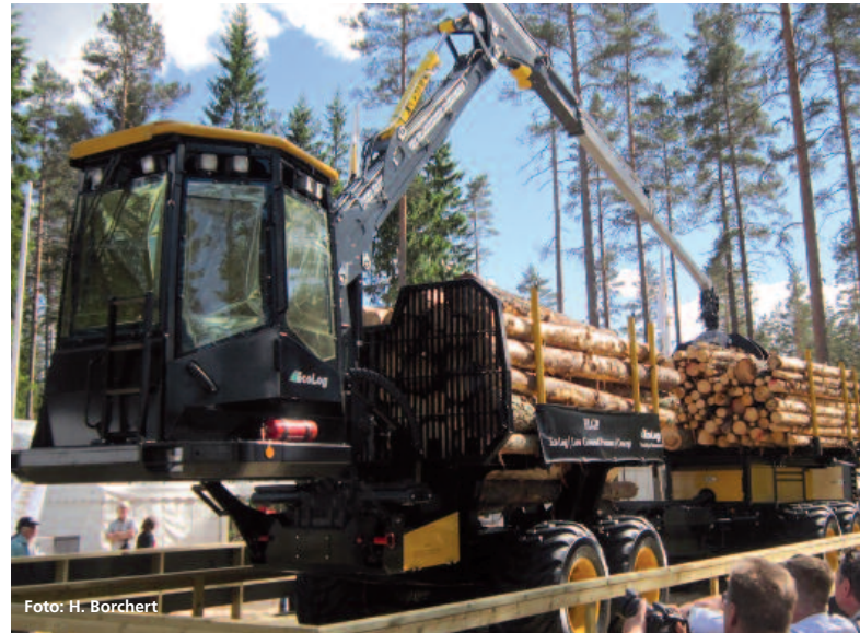
Abbildung 2: Das Forwarderkonzept ELGP spaltete die Elmia-Besucher. Auf der einen Seite eine nie erreichte, optimale Achslastverteilung, andererseits das hohe Gewicht von über 40 t. Was bleibt, sind hohe Radlasten. Deshalb ist es fraglich, ob die Maschine jemals den Weg in bayerische Wälder finden wird.
