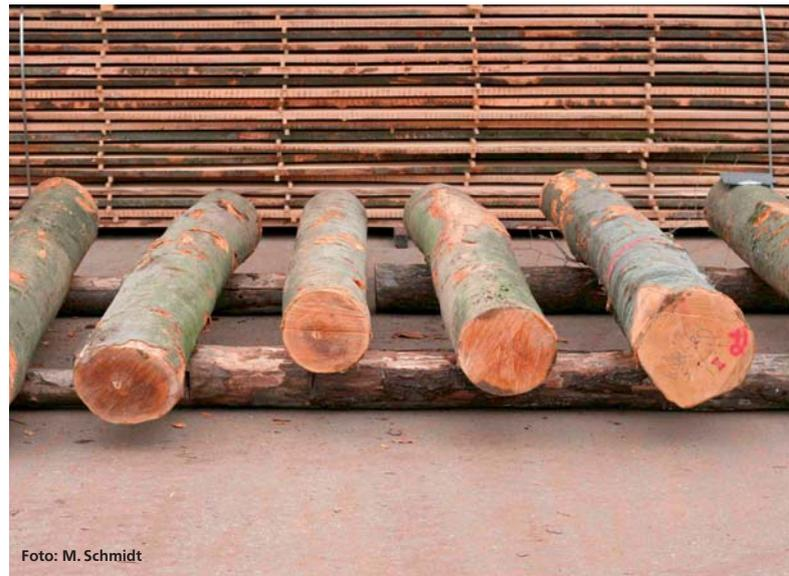
Abbildung 2: Untersuchtes Rundholz der Stärkeklassen L2b und L3a
