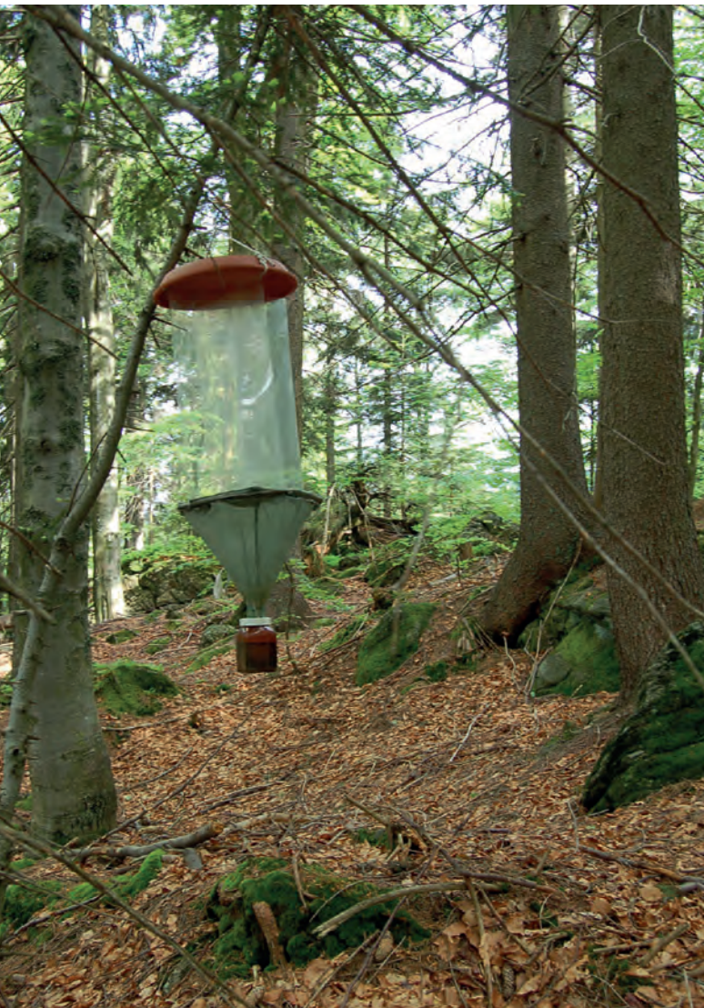
7 Eine Flugfensterfalle besteht aus zwei durchsichtigen Plexiglasscheiben, die kreuzweise miteinander verbunden sind und einem Trichter mit Fanggefäß, in das die Tiere beim Auftreffen auf die Scheiben fallen. Foto: M. Blaschke
