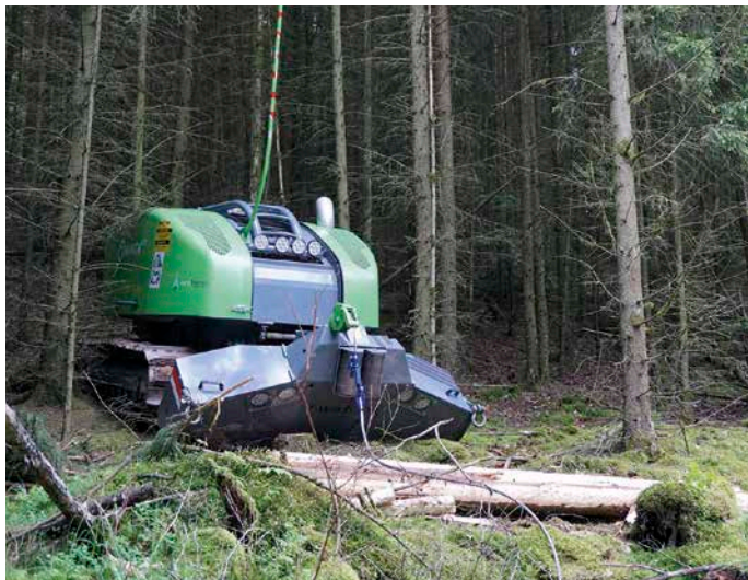
8 Externe Traktionshilfswinde »T-Winch« von Ecoforst: Sie unterstützt den konventionellen Antrieb von Fahrzeugen bis ca. 50 % Hangneigung.
