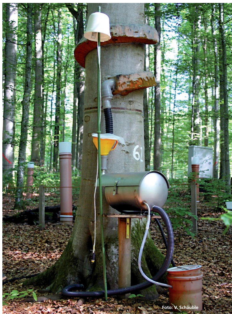
Abbildung 4: Mit einer Stammabflussschicht und mit einem Bestandesniederschlagssammler werden an den Bestandesmessstellen unter anderem die Schadstoffeinträge erfasst, so auch hier am Beispiel der Buchen-WKS in Freising.
