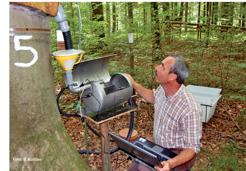
Ein Mitarbeiter der LWF überprüft die Messeinrichtung für den Stammablauf.
